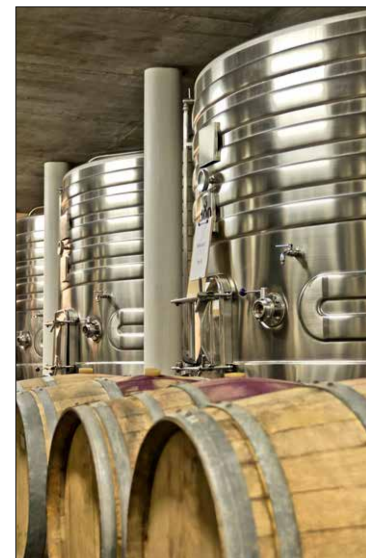
Tanques e barris de estocagem estão entres os pontos da produção sensíveis à presença do oxigênio
